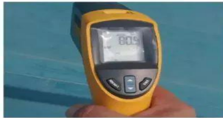
改造前屋顶温度80.9℃
