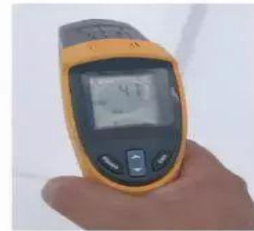
改造后屋顶温度41.7℃
